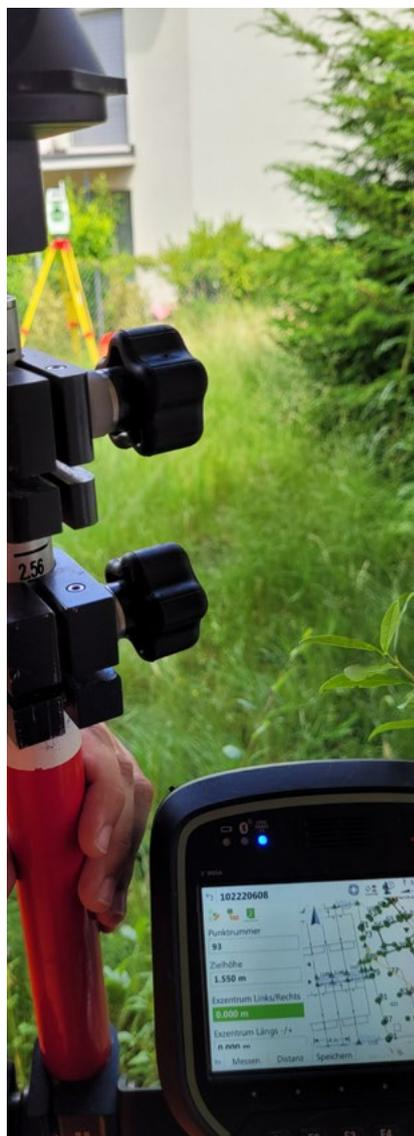
Beim Erfassen von Objekten durch Messcodes profitieren die Geomatiker von Sutter Ingenieure von der codierten Vermessung und dem Modul rmGEO/CodeGrafik, woraus im Handumdrehen ein fertiger Plan entsteht.
