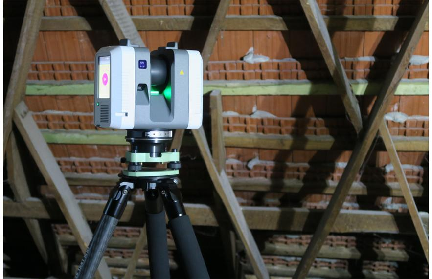
„Ein 3D-Laserscanner ist für die Bestandsaufnahme alter Gebäude und deren Dachkonstruktionen für ein präzises Aufmaß optimal geeignet“, ist Zimmermann Jens Ehrlich überzeugt.
