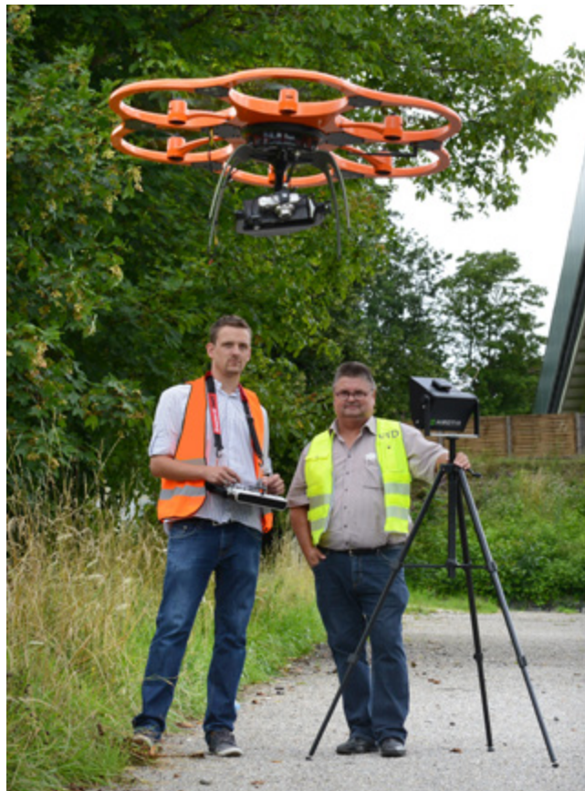
Die Geomatik + Vermessung der Stadt Zürich hat auch eine Drohne im Einsatz, mit der Orthofotos oder Oberflächenmodelle für Kunden bereit gestellt werden.
