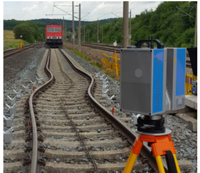
Abbildung 2: Gleis nach der Verwerfung mit dem Laserscanner Z+F IMAGER 5010X im Vordergrund, den Höhentafeln links und rechts auf den Schwellen sowie der Lok als „Widerlager“ im Hintergrund.
