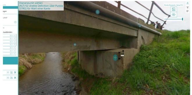
Mit rmDATA 3DWorx holen Planer die Baustelle mitten ins Büro: Alle Details können am Bildschirm komfortabel betrachtet und analysiert werden (oben), wie etwa die Ebenensuche an Brückenbauwerken mit dem Modul „Analyse“ (unten).
