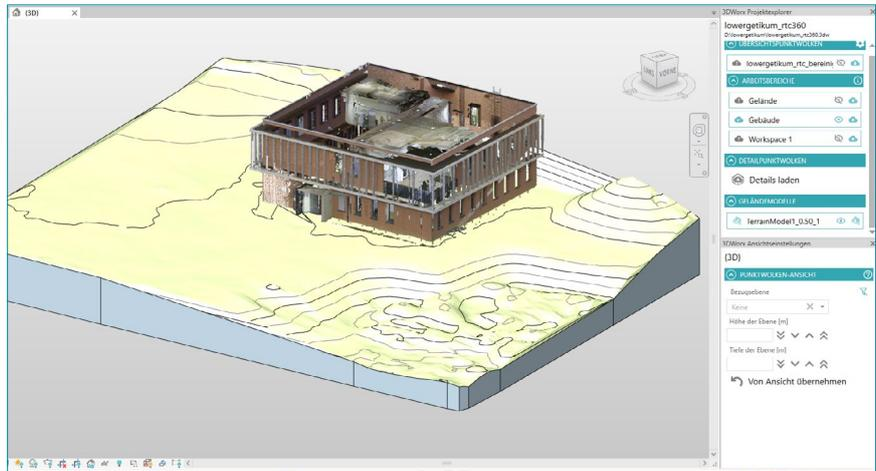
Das 3DWorx Revit-Plugin bringt digitale Geländemodelle mit einem Klick nach Autodesk Revit.
