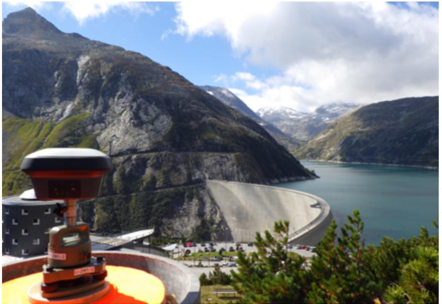
Abbildung 1: Referenzantenne (Vordergrund) in der Nähe der Kölnbreinsperre (Hintergrund).
