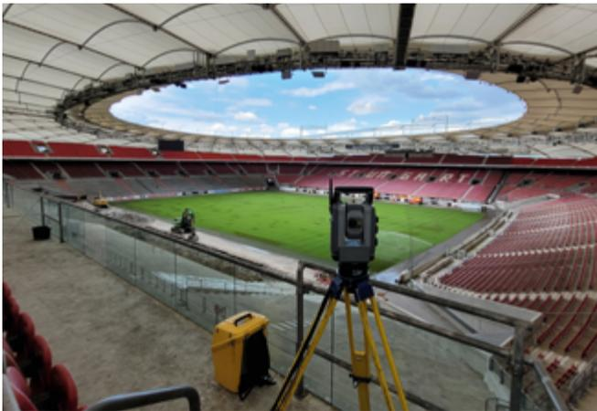
Eine Auswahl an Projekten von intermetric: Fußball EM 2024: Aufbereitung zur Absteckung sowie Erstellung von Bestandsdaten der Haupttribüne im Neckarstadion
