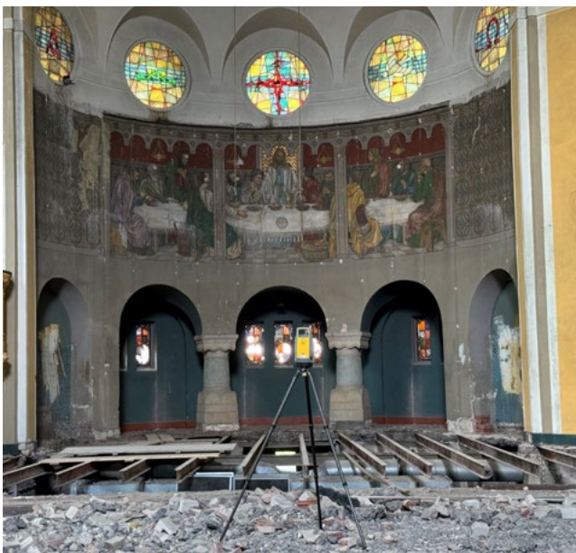
Laserscan-Aufnahmen im Innenraum der brandgeschädigten Kirche in Bochum.
