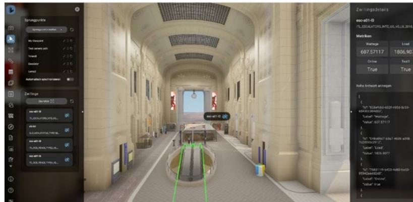
Abbildung 5: Die Rolltreppe im 3D-Modell ist mit Sensordaten verknüpft.
