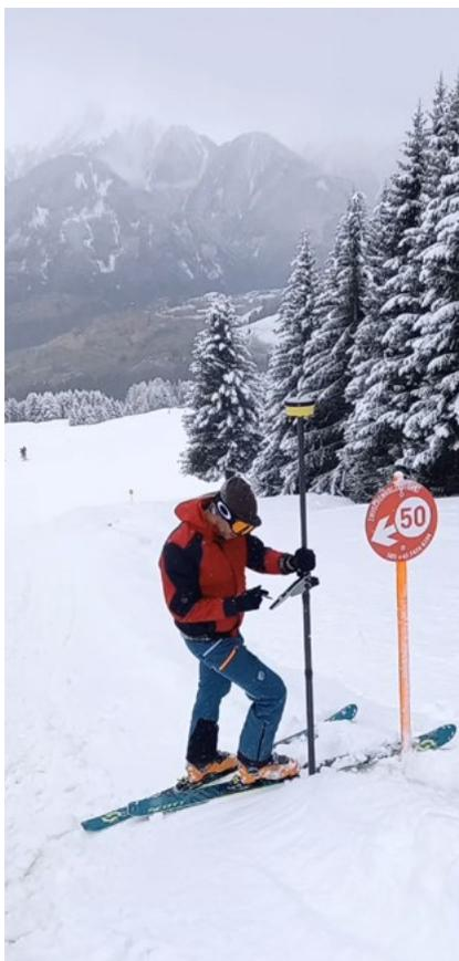
Sämtliche Pistenschilder und Absperrungen im Skigebiet wurden mittels GNSS-Messungen in der mobilen Anwendung rmDATA Mobile erfasst.
