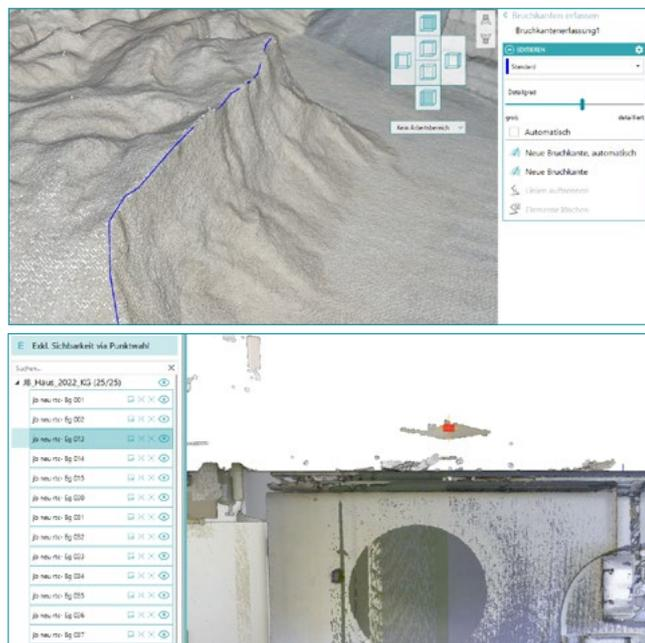
Neu: Das Erfassen, Bearbeiten und Exportieren von Geländekanten aus dichten Punktwolken (oben), der neue Standpunkt-Explorer (unten).
