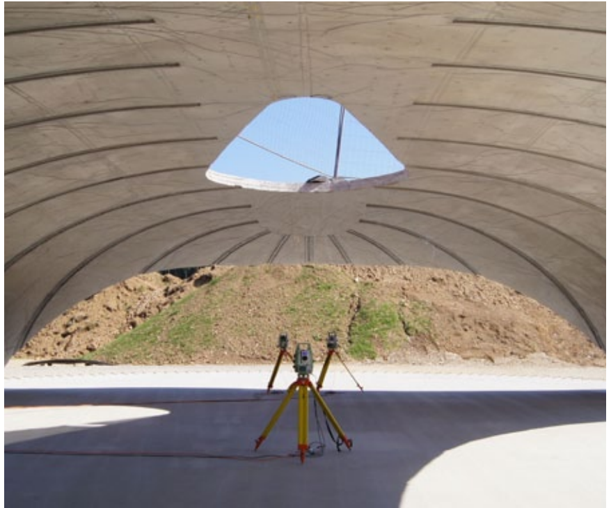
Abbildung 1: Überwachung einer Freiformschale mit einem terrestrischen Laserscanner
