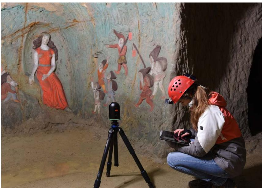
Abb. 1: Steuerung des Leica BLK360 im Bergwerk über ein Tablet mit *ReCap Mobile* von Autodesk
