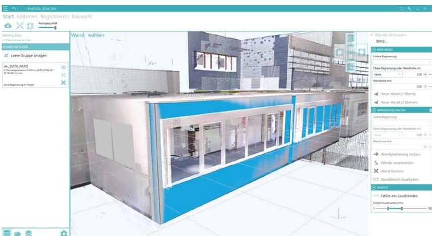
**Fassadenpläne: 3D Worx findet Kanten über den Verschitt automatisch detektierter Ebenen.**
